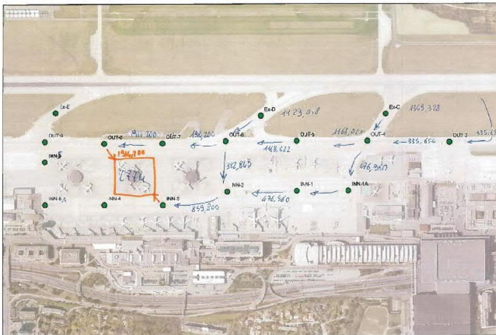
Illustration du raisonnement pour l'évaluation de la répartition du trafic des avions par tronçon, pour une arrivée au satellite SAT30.
